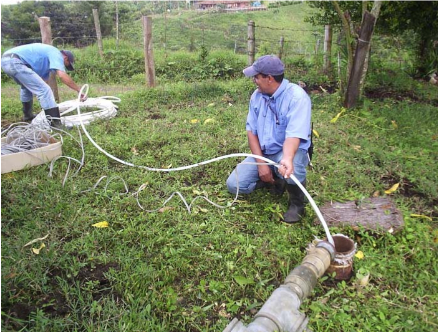
Foto 8. Prueba de abatimiento del Pozo La Gramínea
